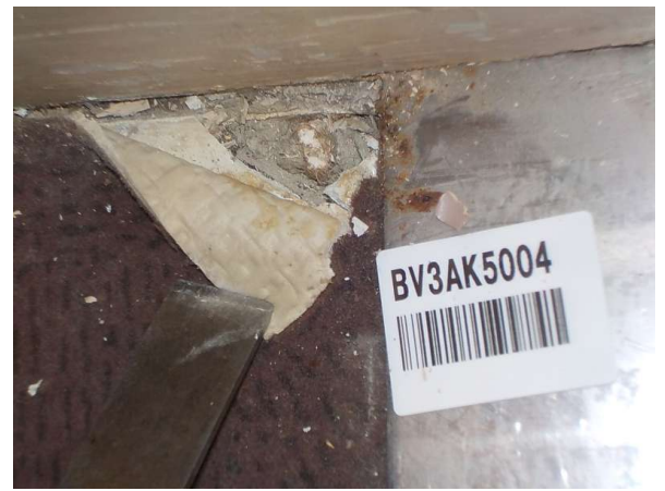
Prélèvement - P20 : Bâtiment principal / R+1 / Circulation Nord - Dalle de sol - EP- (Présence d'amiante)
