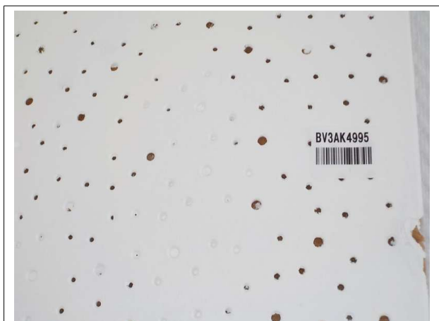
Prélèvement - P11 : Bâtiment principal / RDC / Service médical / Bureau DRH adjointe - Faux plafond- (Absence d'amiante)
