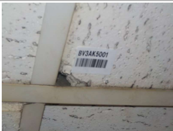
Prélèvement - P17 : Bâtiment principal / R+1 / Circulation Est - Faux plafond- (Absence d'amiante)
